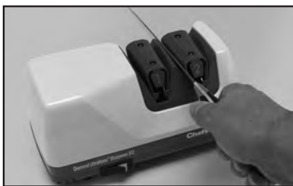
Afbeelding 6. Steek het lemmet in de linkersleuf van Fase 2. Wissel individuele slijpbewegingen af in de linker- en rechtersleuven.
