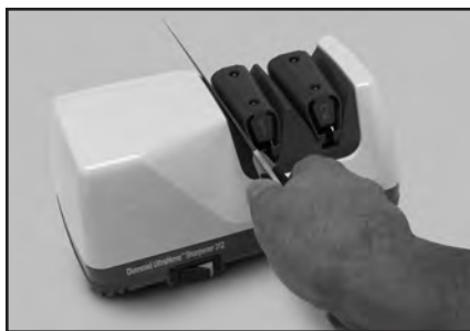
Afbeelding 3. Fase 1. Steek het lemmet in de sleuf tussen geleidingsrol en elastomere veer. Wissel enkele slijpbewegingen af in de linker- en rechtersleuven.
