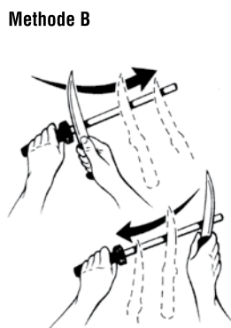
Methode B – Strijkbewegingen wég van de snede
